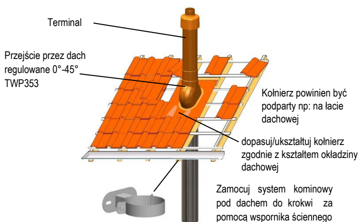
Rys 8 Przykład uszczelniania przejścia przez dach.
