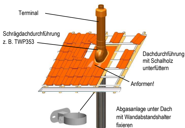
Abb. 8 Schrägdach mit typischer Dachhochführung
