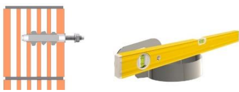
Abb. 3 Beispiel, Injektionsankerbefestigung bei Mauerwerk
