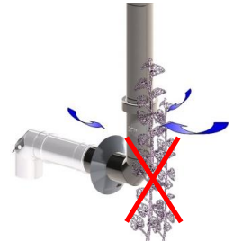
Abb. 5 Verbrennungsluft-Ansaugung frei halten
